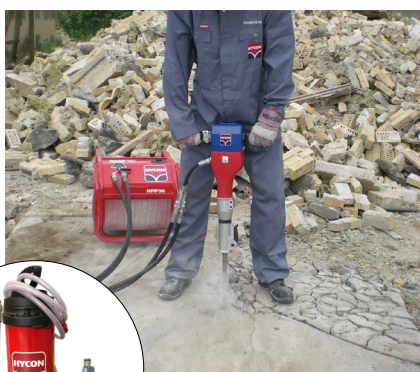
Optional: Staubunterdrückungs-Kit, Artikelnr. 1113286 HYCON Wasserbehälter, Artikelnr. 3030051
